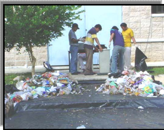
Fotos 13 y 14. Obtención del Peso Volumétrico in situ.
