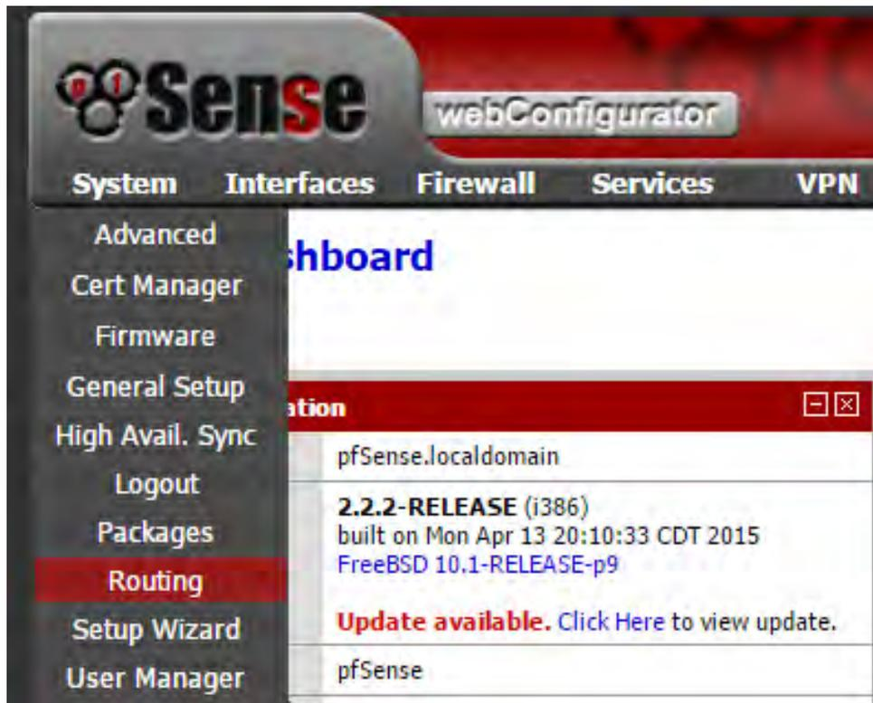
Figura 7.53 Paso 1, Creación de ruta estática en pfSense.
