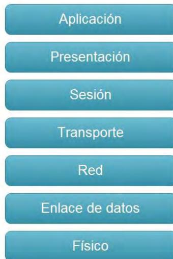
Figura 2.1 Niveles del modelo OSI
