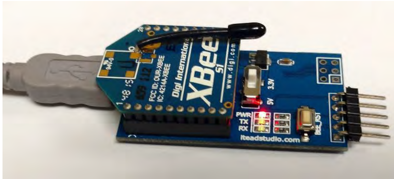
Figura 49. Módulo Xbee Coordinador transmitiendo.
