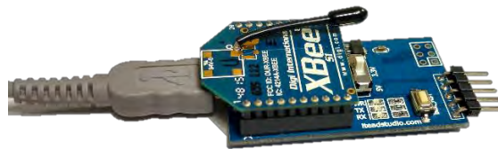
Figura 19. Conexión módulo Xbee y Adaptador Xbee.
