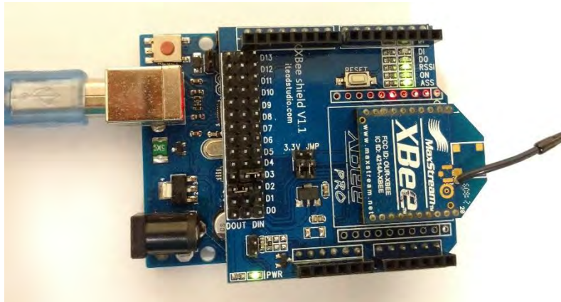
Figura 51. Dispositivo Final recibiendo los datos del módulo Coordinador.
