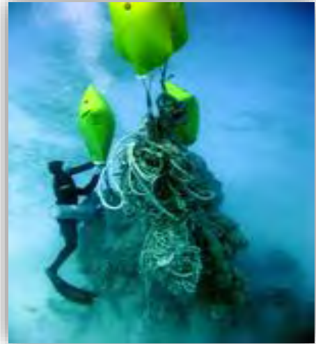
Figura 4. Bolsas de aire, método eficaz para retirar del fondo de mar toneladas de artículos de pesca. Fuente: (PIFSC & NOAA, 2011). Foto: NOAA.
