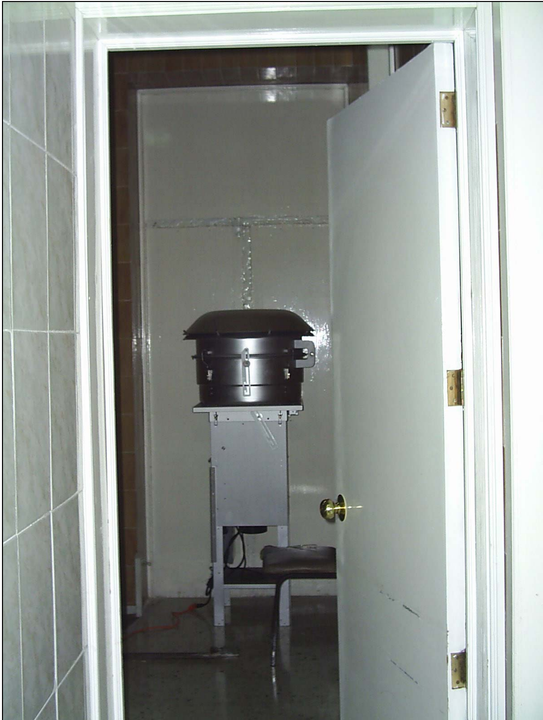
Figura 7. Equipo de PM_{10} en la estación de monitoreo del Hospital Materno Infantil Morelos, sala de rayos "X".
