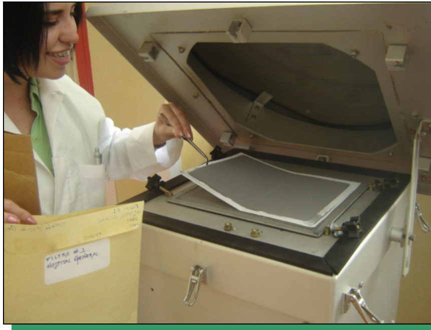
Figura 2. Equipo de PM 10 en el Hospital General Chetumal Quintana Roo, sala de hospitalización
