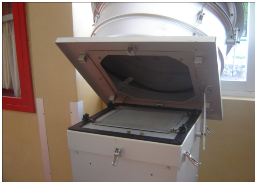
Figura 3. Equipo de PM 10 en el Hospital General Chetumal Quintana Roo, sala de hospitalización
