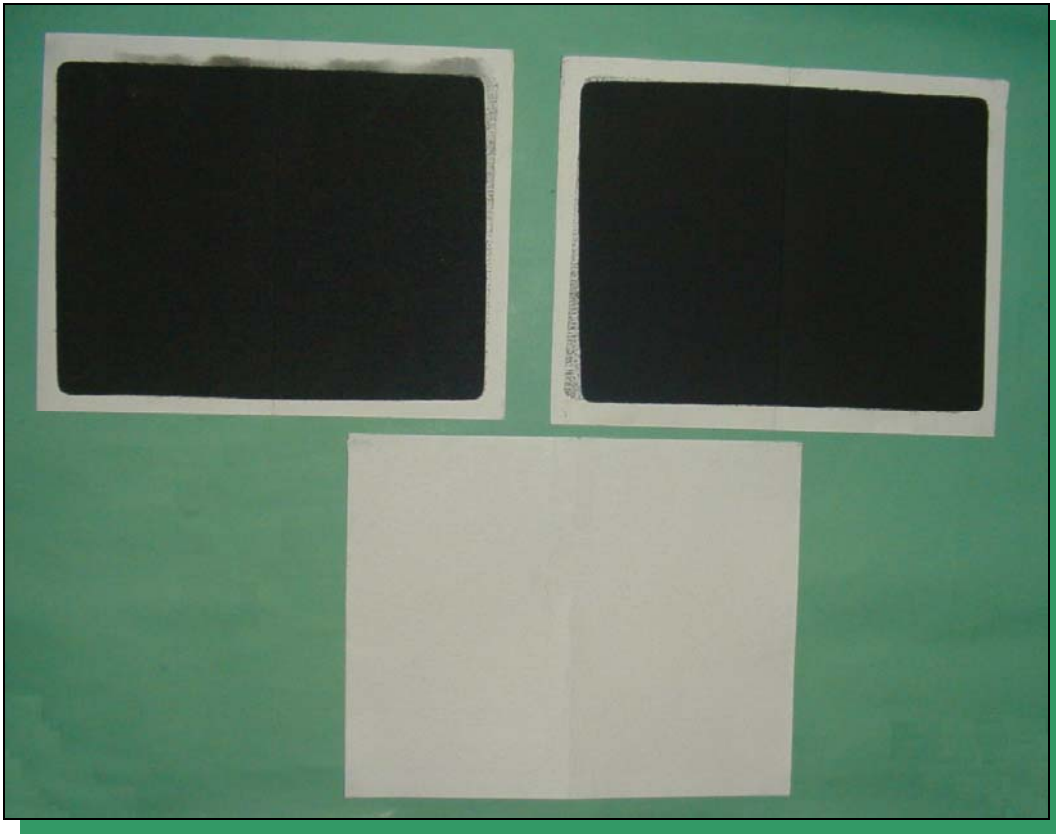
Figura 11. Filtros con concentraciones de PM_{10} en el Hospital Materno Infantil Morelos y un blanco.
