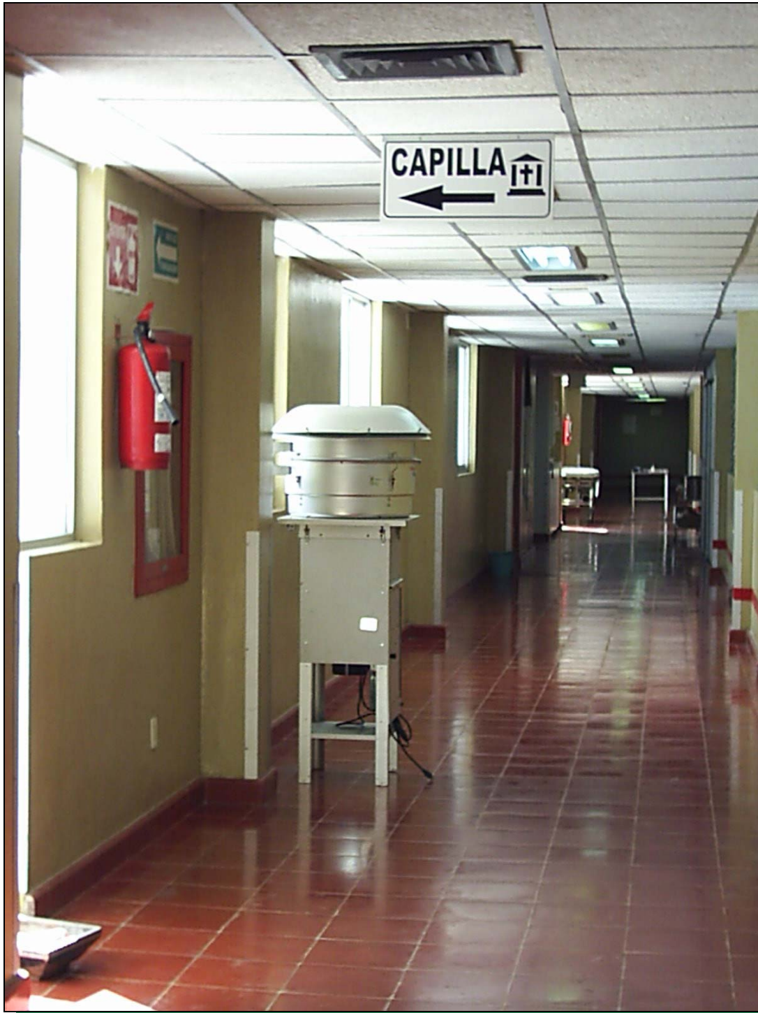
Figura 6. Equipo de PM_{10} en la estación de monitoreo Hospital General Chetumal Quintana Roo, sala de hospitalización.
