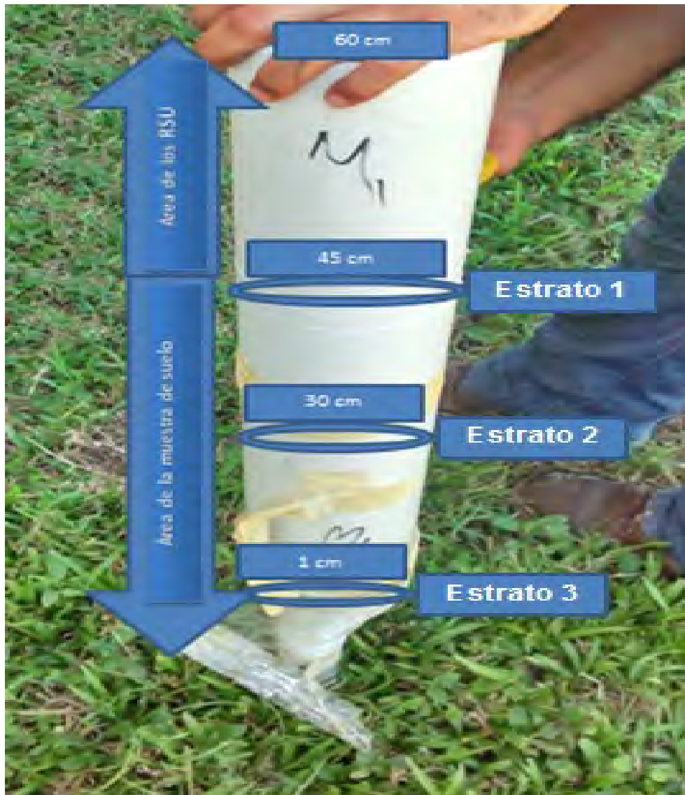
Figura 2.2. Esquema de cortes para los tubos
