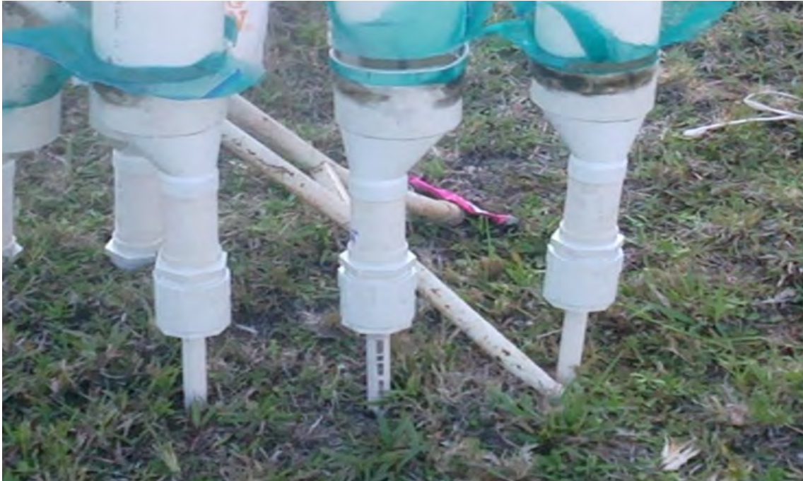
Imagen 2.2.3. Reductores hidráulicos de 4 pulgadas a \frac{1}{2} pulgada.
