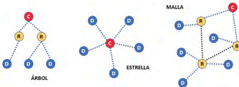
Figura 4.4: Topologías de Red ZigBee y los roles que pueden adquirir los dispositivos.
