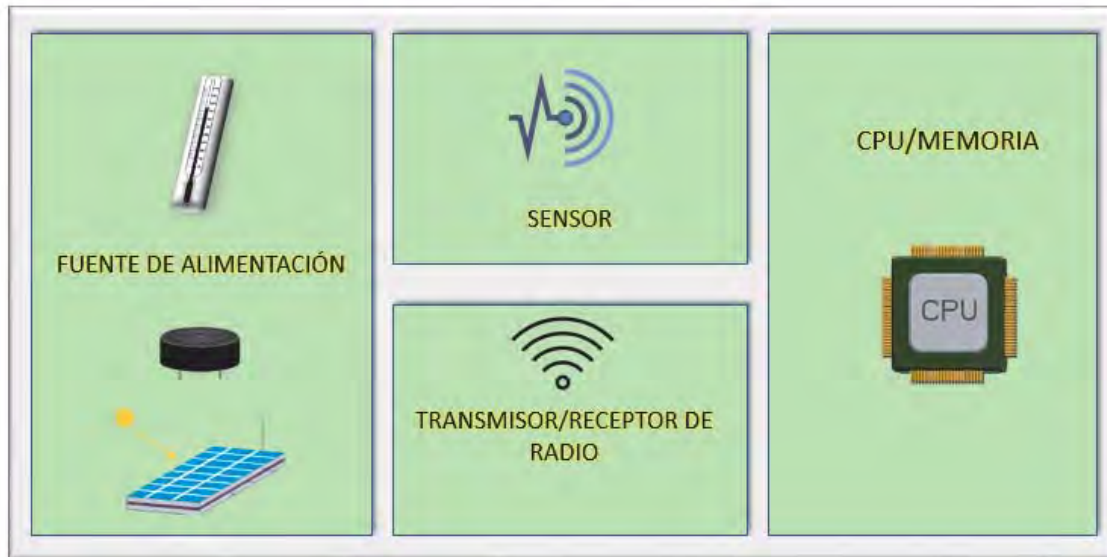
Figura 1.1: Elementos Principales de un Dispositivo para WSN.
