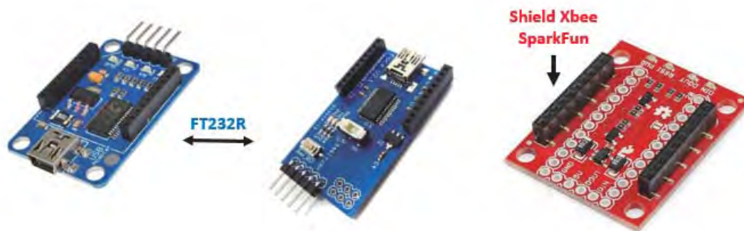
Figura 4.7: Tarjetas Electrónicas para la Comunicación del Módulo Xbee con la Computadora.
