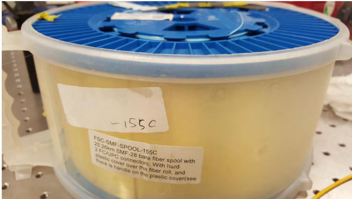
Figura 23 25km de Fibra SMF-28 Bare Fiber Spool Utilizado
