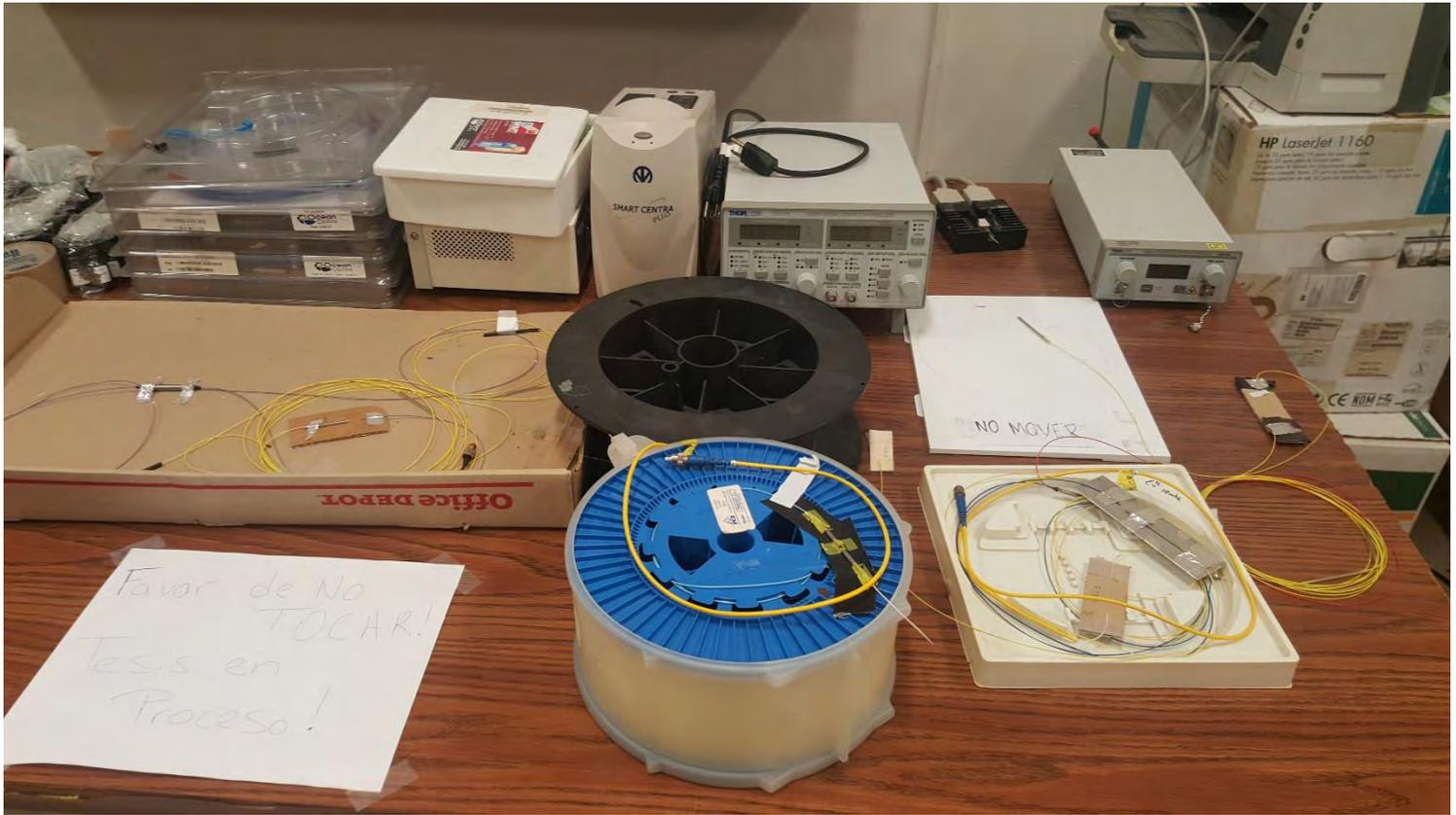
Figura 17 Implementación del Arreglo Óptico para la Caracterización del Esparcimiento Brillouin Estimulado
