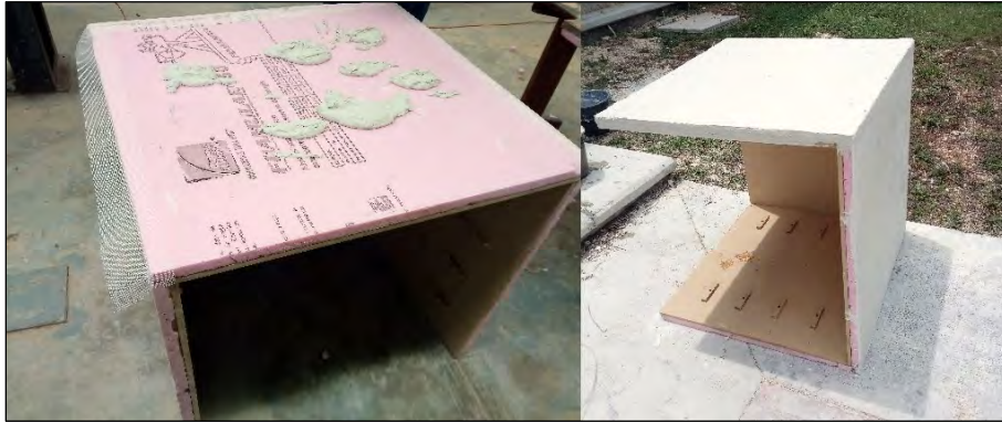
Figura III. 11. Proceso de recubrimiento de Crestuco para la protección del Foamular.
