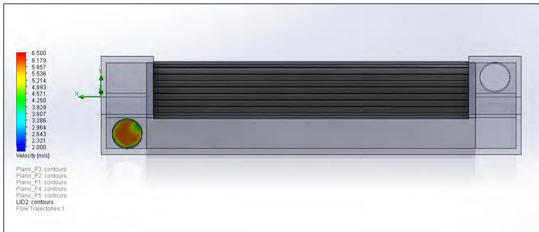
Figura V. 18. Velocidad del aire obtenida a la salida de la tubería del colector solar (B) en la simulación CFD.
