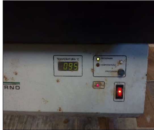
Figura IV. 39. Temperatura usada en el horno eléctrico para las muestras para el producto seco.
