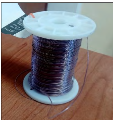
Figura III. 21. Alambre termopar tipo T, usado para la evaluación del sistema de secado.
