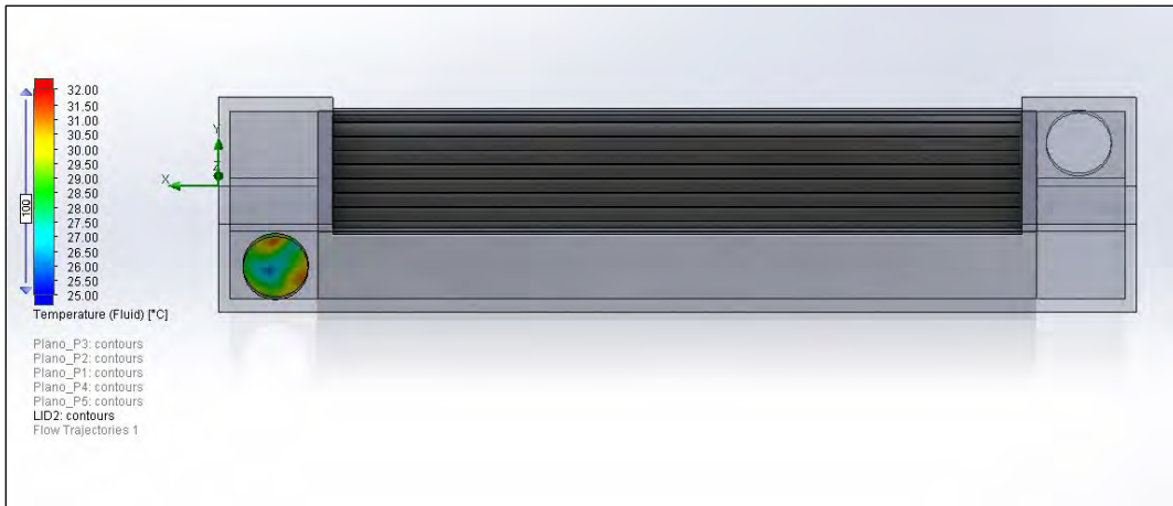
Figura V. 17. Temperatura del aire obtenida a la salida de la tubería del colector solar (B) en la simulación CFD.
