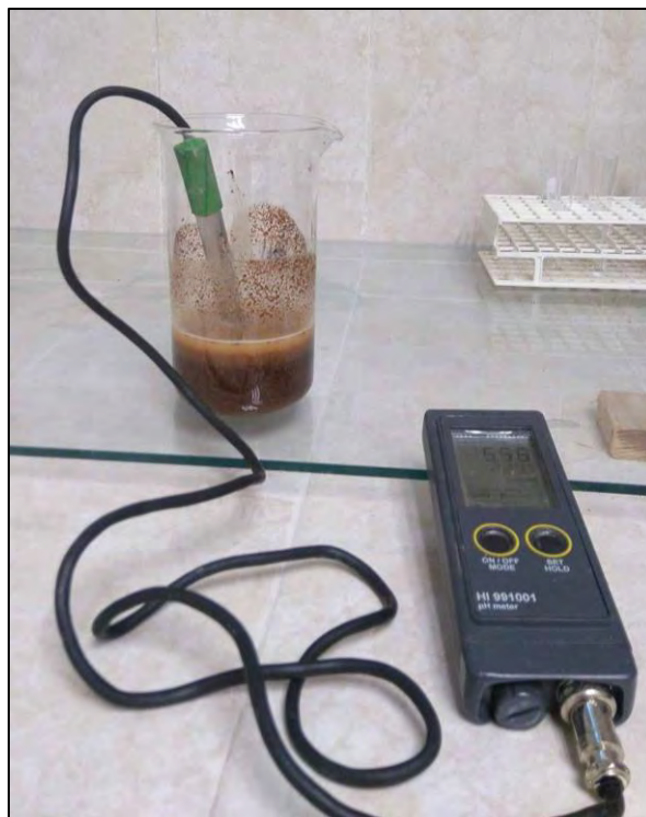
Figura 10. Neutralización del hidrolizado.
