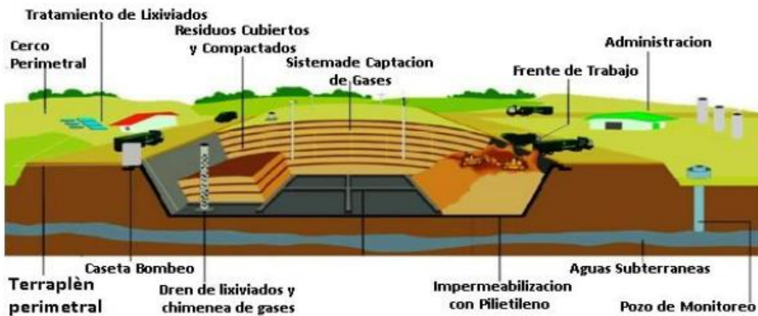
Figura 1.4 Componentes del relleno sanitario
