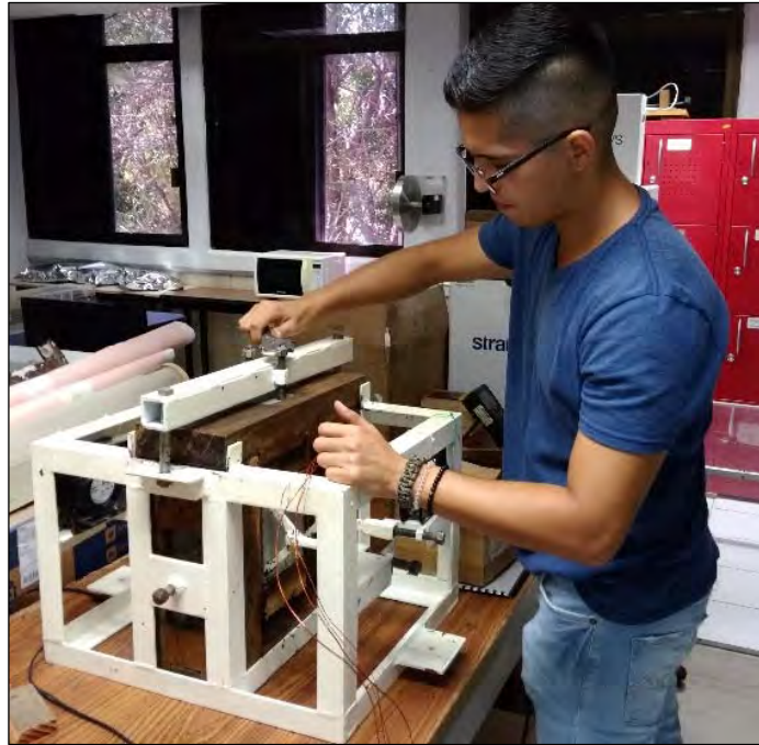
Figura 12.- Fotografía del ensamblaje del Conductímetro ya aislado adiabáticamente con silicón térmico.
