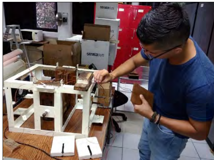
Figura 11.- Fotografía de colocación de termopares en el Conductímetro antes de ser ensamblado.
