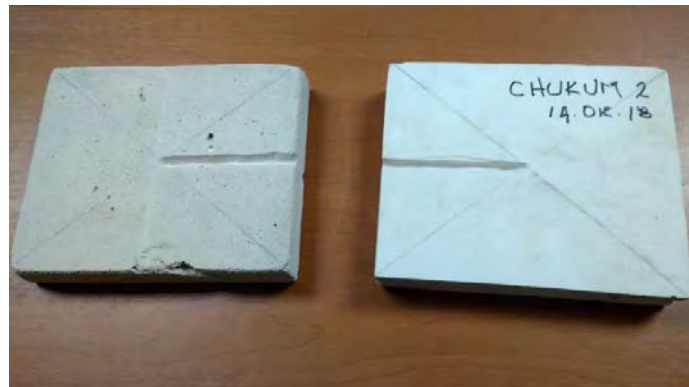
Figura 5.- Fotografía de los especímenes de chukum con sus canalizaciones para termopares.
