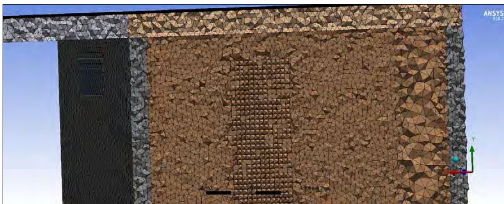
Figura 41. Vista de la malla del modelo con corte transversal a una altura inmediata antes de la puerta del baño. Fuente: Elaboración propia.
