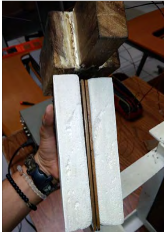
Figura 10.- Secuencia espécimen-placas calefactoras-espécimen antes de colocar en Conductímetro.
