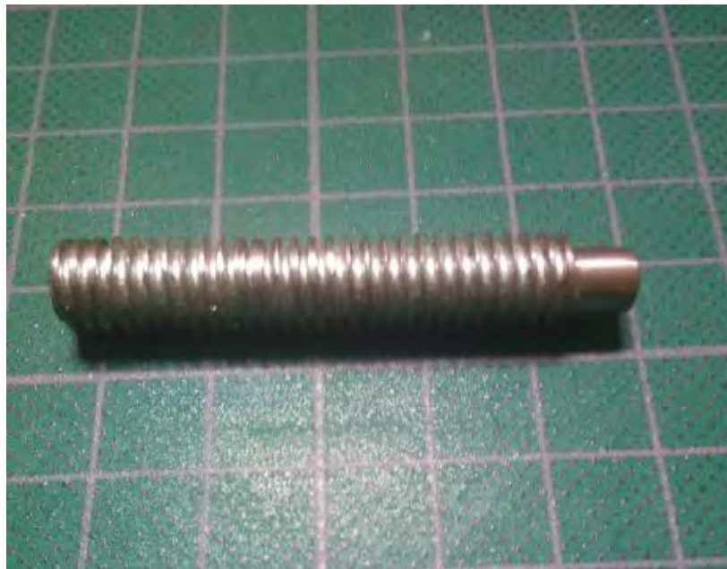
Figura 16: husillo del inyector de silicón
