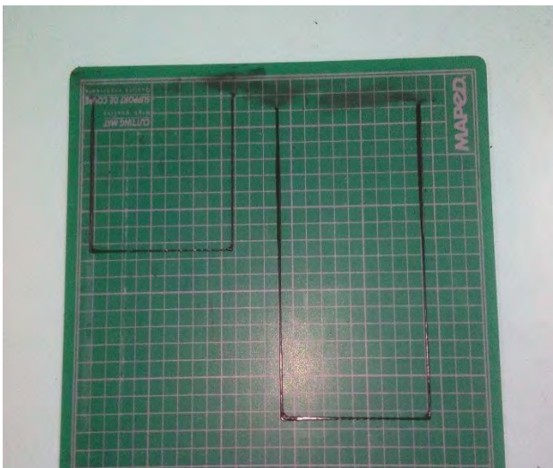
Figura 30: Extrusiones realizadas durante las pruebas de inyección.
