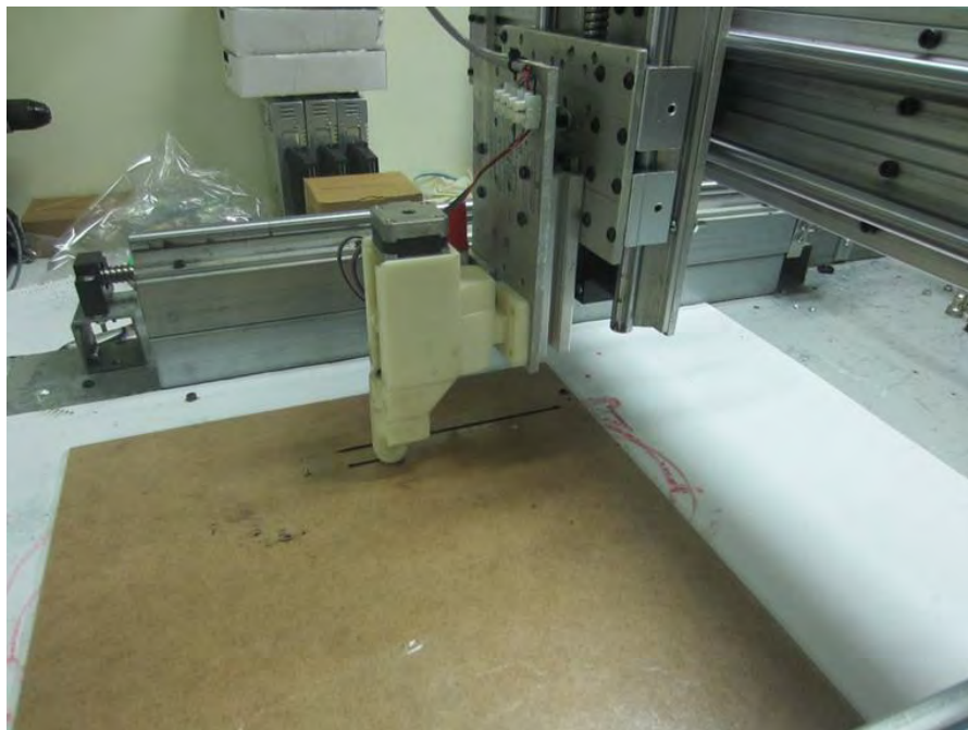
Figura 31: inyector de silicón operativo.
