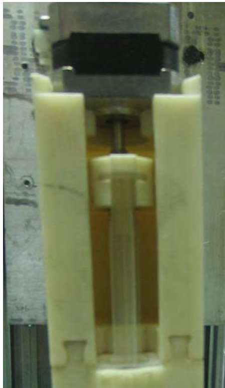
Figura 15: Ensamble husillo-embolo mediante el acoplamiento y base del actuador
