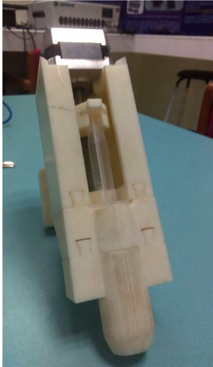
Figura 25: inyector de silicón listo para ser montado en el CNC
