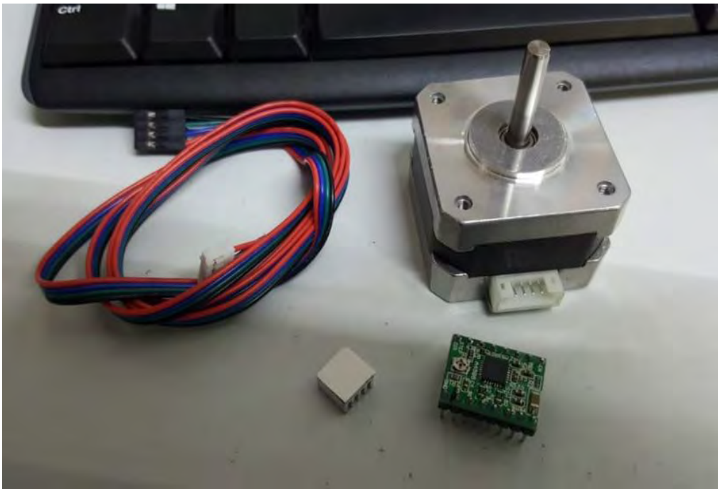
Figura 20: Actuador, motor a pasos NEMA 17 42 x42 mm
