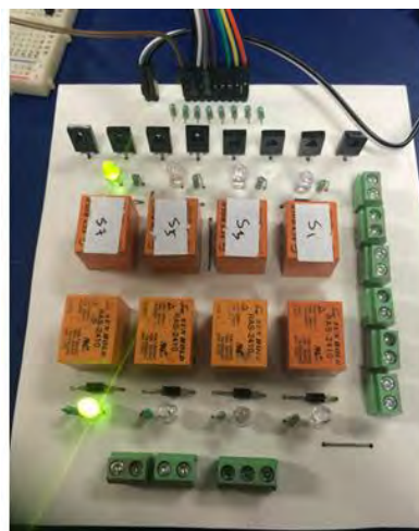
Fig. 2.18 Indicadores de los interruptores de transferencia
