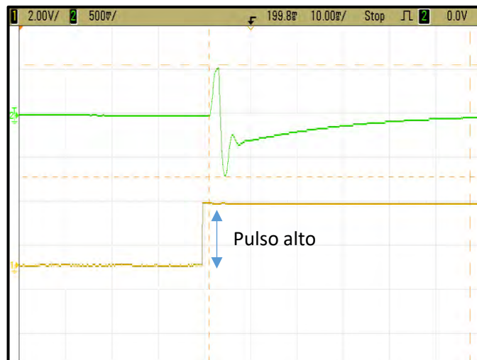
Figura 4.11 Comportamiento del PI al demandarle 100 W usando un capacitor de 0.1 \mu F.
