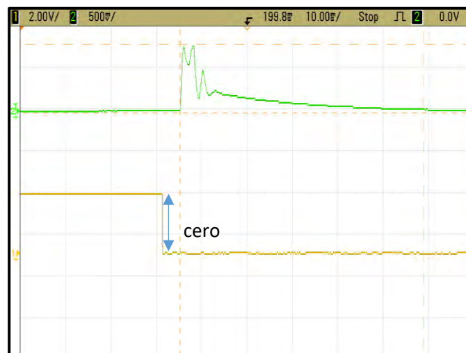
Figura 4.12 Comportamiento del PI al demandarle 50 W usando un capacitor de 0.1 \mu F.
