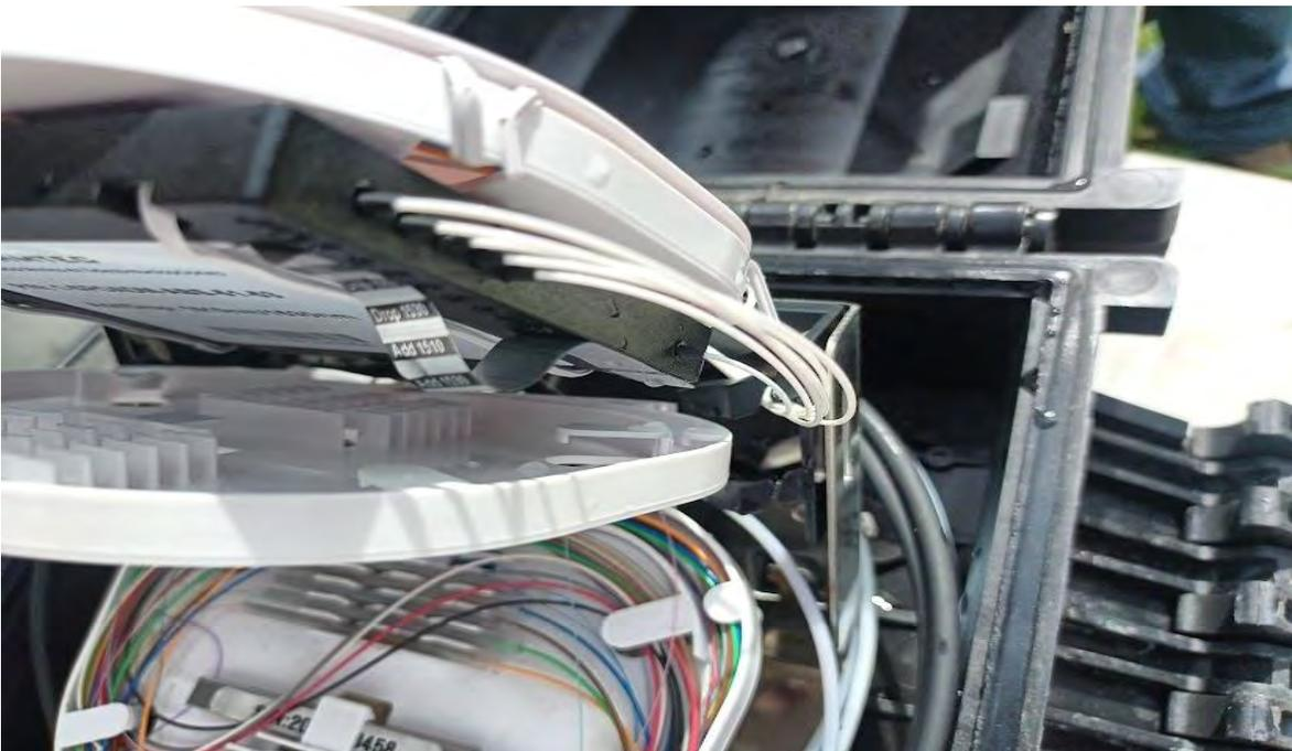
*Ilustración 36 Dispositivo OADM CWDM con 8 longitudes de onda en caja de empalme (vista 2)*
