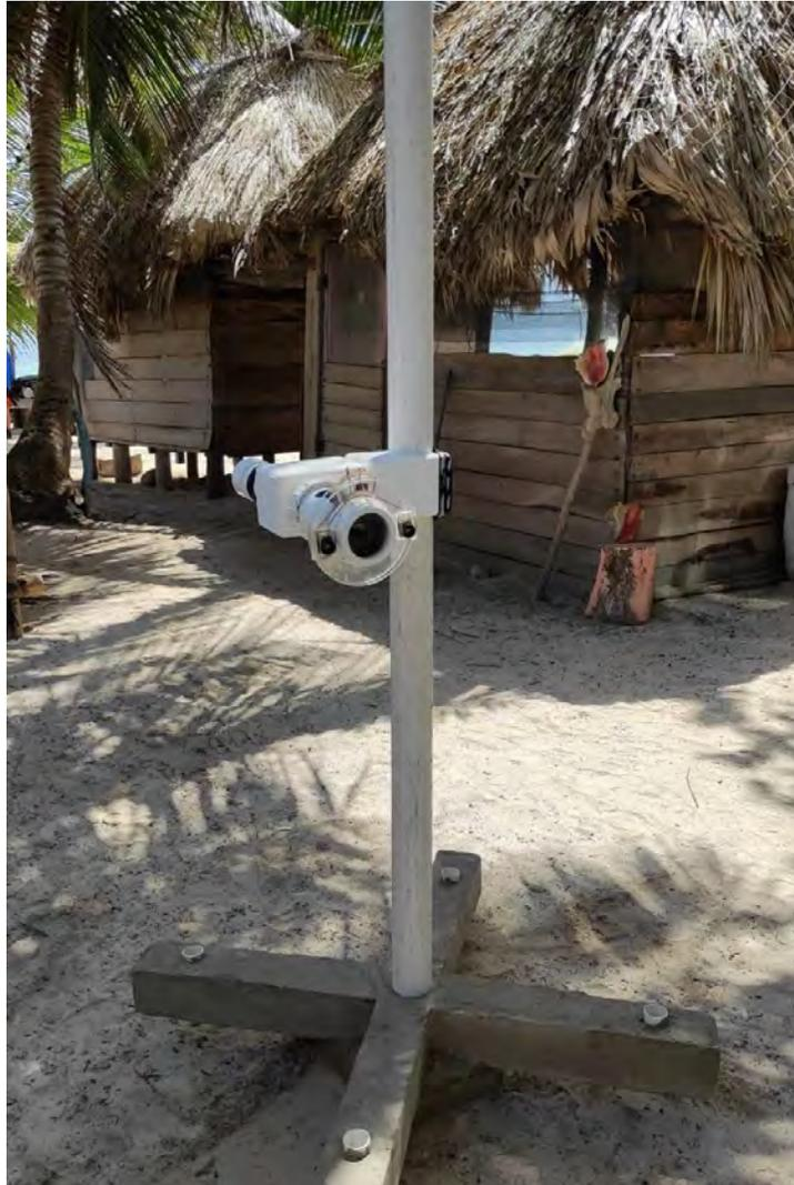
**Figura 37.- Estructura con la cámara montada**
