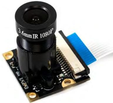
Figura 14. Cámara Raspberry Pi
