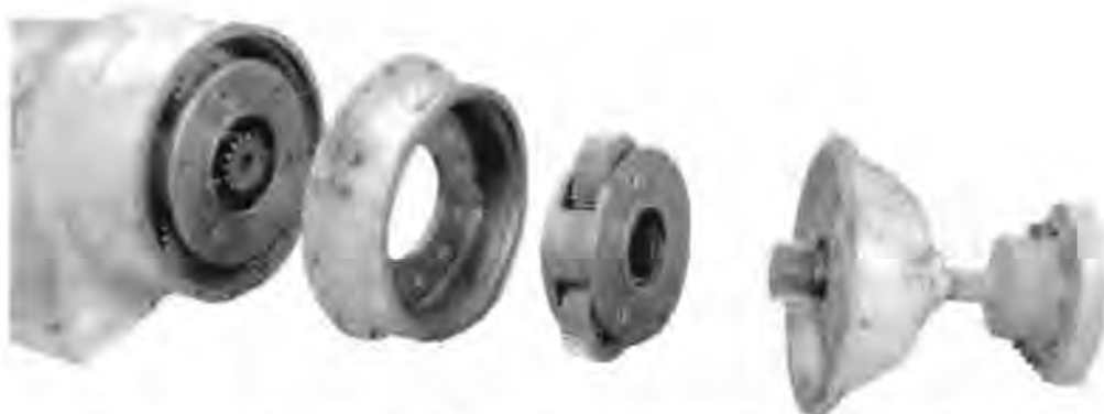
Figura 15, Vista esquemática de una multiplicadora planetaria de dos etapas. "Wind Energy Explained Theory, Design and Application." Manwell, et al, (2004)
