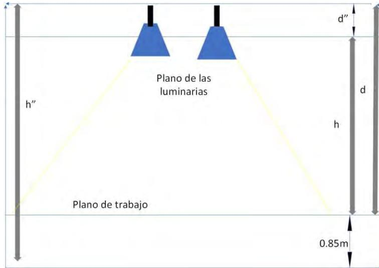
Ilustración 8. Altura entre plano de trabajo y luminarias
