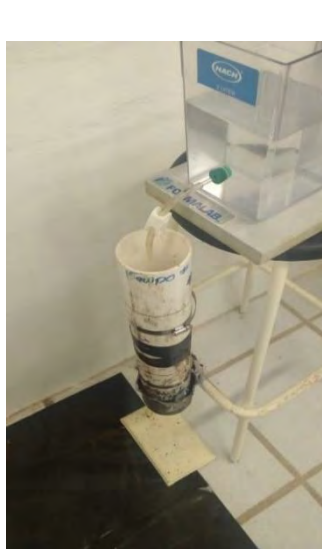
Fotografías: Muestreo en campo para realizar el experimento de conductividad hidráulica; prototipo y experimentación en laboratorio de la conductividad hidráulica. Experimento elaborado en el Laboratorio de Química Ambiental.
