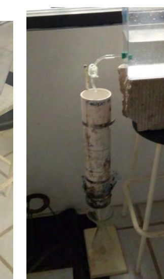
Fotografías: Muestreo en campo para realizar el experimento de conductividad hidráulica; prototipo y experimentación en laboratorio de la conductividad hidráulica. Experimento elaborado en el Laboratorio de Química Ambiental.
