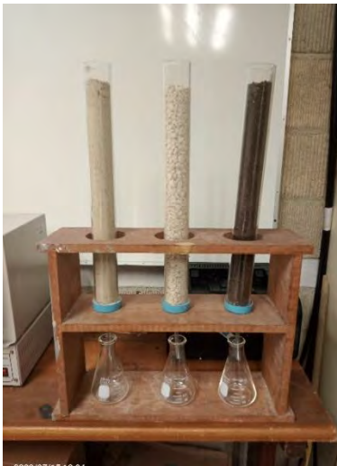
Fotografías: prototipo y experimentación de filtrado, toma de pH y conductividad de los lixiviados. Experimento elaborado en el Laboratorio de Ingeniería Ambiental.
