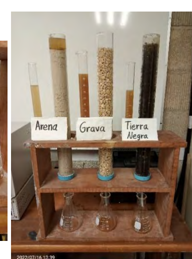
Fotografías: prototipo y experimentación de filtrado, toma de pH y conductividad de los lixiviados. Experimento elaborado en el Laboratorio de Ingeniería Ambiental.
