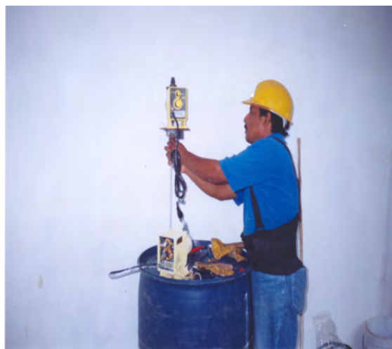
Fig. 15.- Hipoclorador usado por CAPA. (Comisión de Agua Potable y Alcantarillado, Chetumal Q. Roo, septiembre de 2007)
