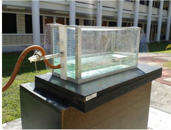
Figura 14. Contenedor del agua de lluvia en el inicio del proceso de tratamiento.
