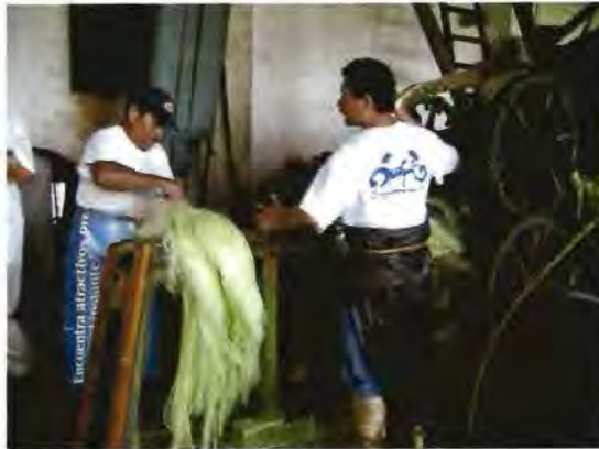
Imagen 17. Proceso de fabricación de la fibra de henequén
