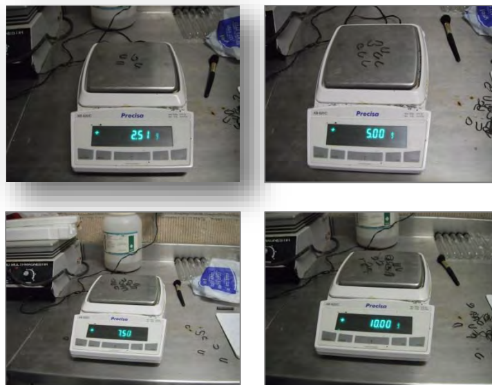
Figura 3.2: Pesaje del alambre recocido
