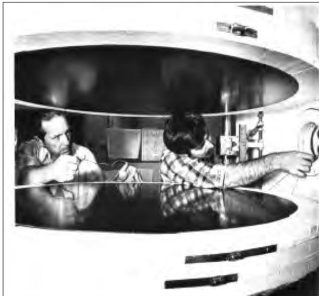
**Figura 6.** El técnico John McAuley y Rick Petersen instrumentando el nuevo 1000-mm de placa caliente guardada.
