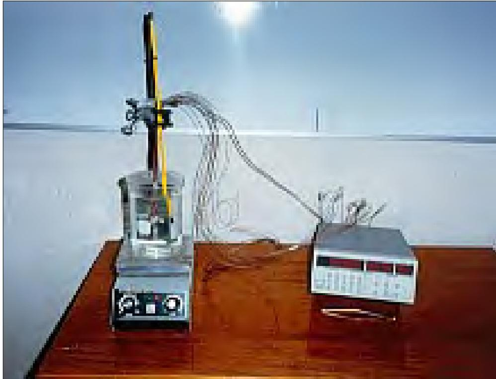
**Figura 2.11** Equipo utilizado en la calibración de termopares
