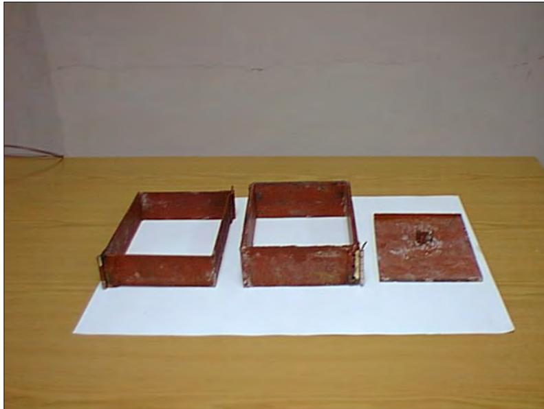
**Figura 3.1** Moldes de hierro para elaborar los especímenes de yeso
