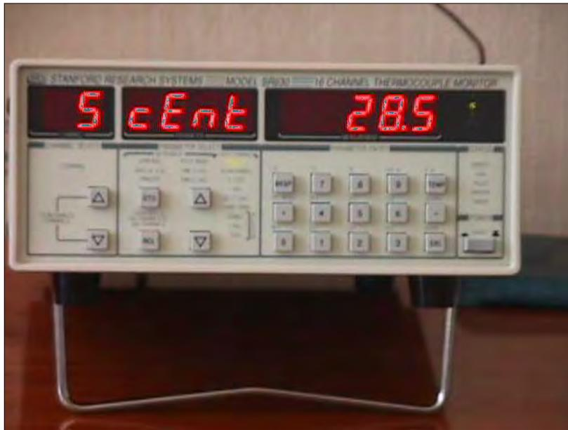
Figura. 2.8 Monitor de termopares de 18 canales
