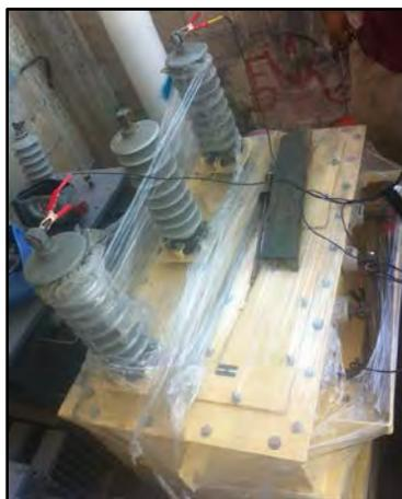
**Figura 31.** Medición de la resistencia de aislamiento.
