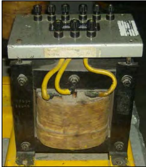
**Figura 8.** Núcleo tipo acorazado.
