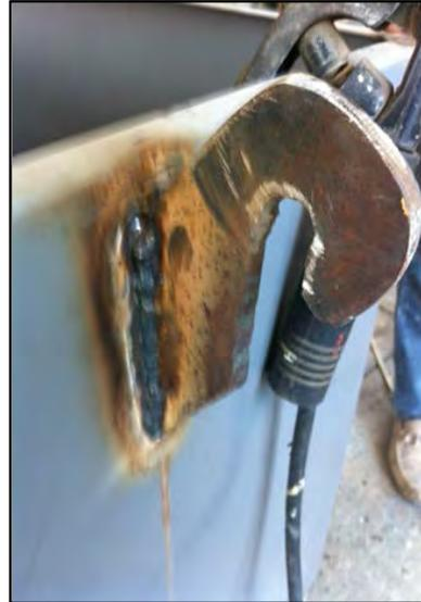
**Figura 28.** Soldadura del soporte del transformador.
