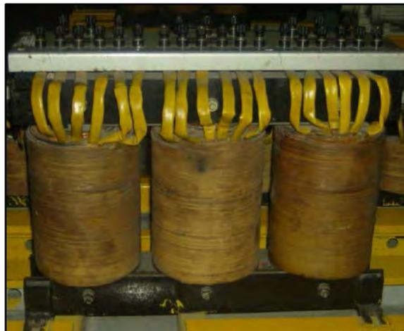
**Figura 9.** Núcleo no acorazado o tipo columnas (trifásico).
