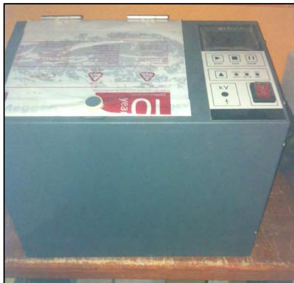
**Figura 33.** Chispómetro o probador de rigidez dieléctrica del aceite.
