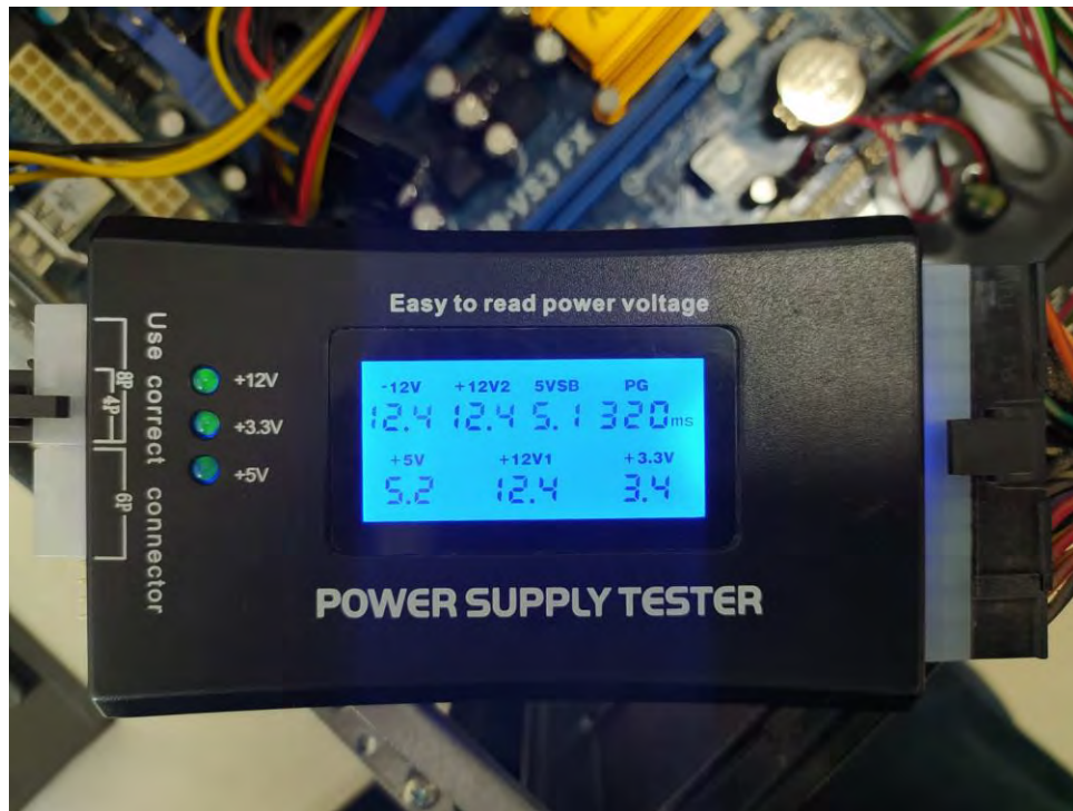
Figura 18 Test de fuente de poder Fuente: Elaboración Propia
