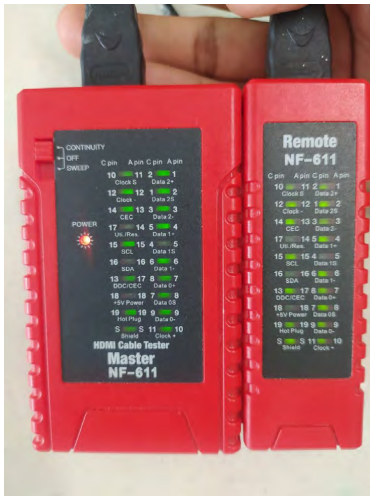
Figura 17 Test de cable HDMI Fuente: Elaboración Propia
