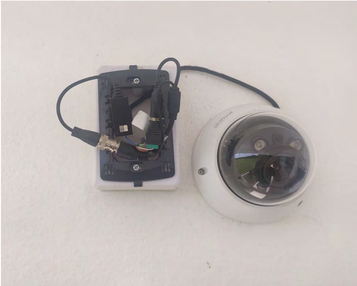
Figura 11 Conexión de cámara tipo domo Fuente: Elaboración Propia
