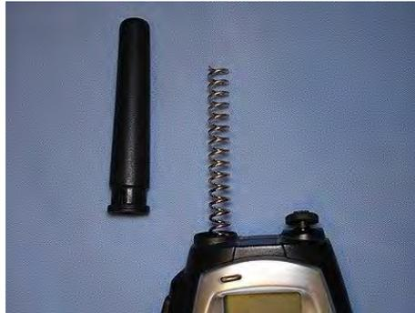
Figura 19 Antena de hélice.
