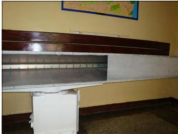
Figura 26 Antena de ranura del radar marino. (Isolution, 2020)
