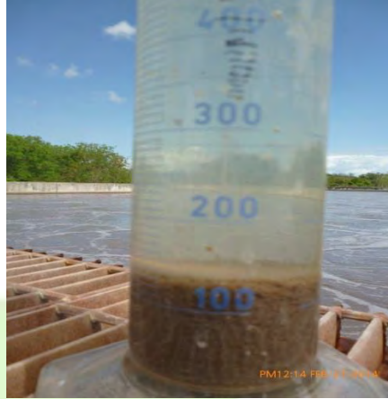
Fig. 2.1.- Toma de muestra en el Biorreactor para la determinación del IVL.
