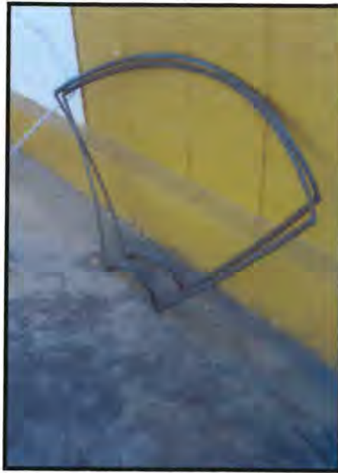
Fig. 9. Construcción del soporte de la superficie reflectora
