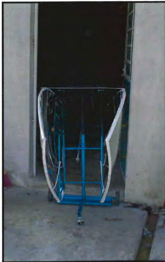
Fig. 20, 21 y 22. Aquí se puede observar lo fácil que es manejar ésta estufa para cualquier usuario, ya que su mecanismo en forma de alas se abate verticalmente cuando no esté en funcionamiento. De esta forma, adquiere dimensiones compactas y protege la superficie reflejante de influencias externas. Al estar dotada con ruedas puede pasar por cualquier puerta de una casa. Esto presenta una gran ventaja ya que a simple vista parece un artefacto muy aparatoso pero es fácil de guardar y transportar cuando no esté en uso.
