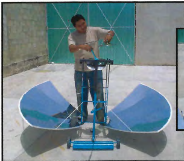
Fig. 17, 18 y 19. En estas fotografías se muestra a un usuario orientando de manera fácil la estufa solar para un óptimo desempeño. El cocinero(a) puede estar de pie sobre el suelo mientras cocina. Esto garantiza también que cuando haya que remover la comida con fuerza esté seguro de pie.
