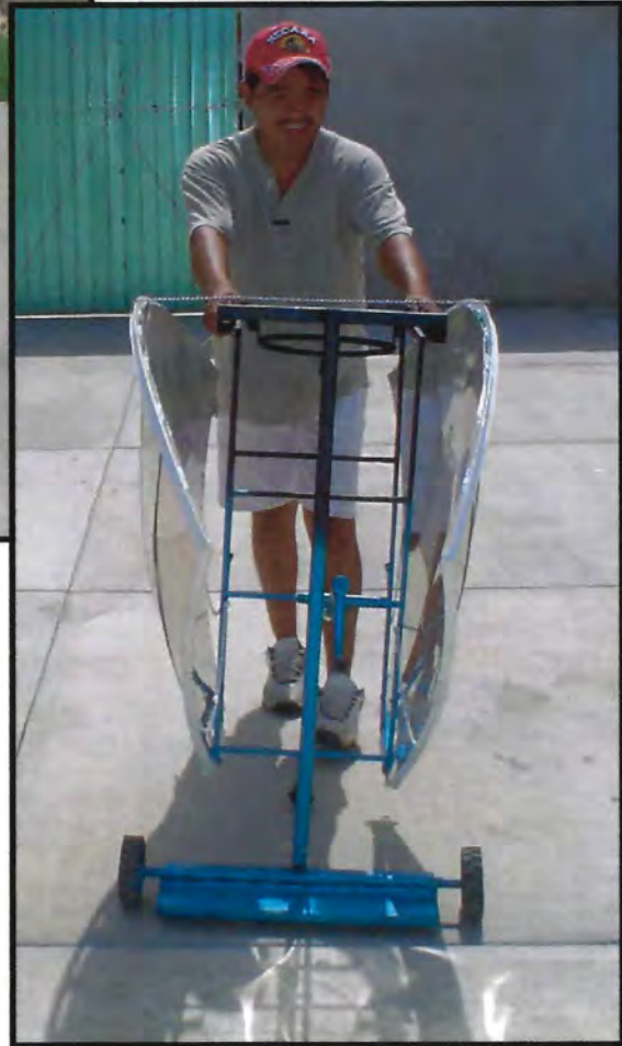
Fig. 20, 21 y 22. Aquí se puede observar lo fácil que es manejar ésta estufa para cualquier usuario, ya que su mecanismo en forma de alas se abate verticalmente cuando no esté en funcionamiento. De esta forma, adquiere dimensiones compactas y protege la superficie reflejante de influencias externas. Al estar dotada con ruedas puede pasar por cualquier puerta de una casa. Esto presenta una gran ventaja ya que a simple vista parece un artefacto muy aparatoso pero es fácil de guardar y transportar cuando no esté en uso.
