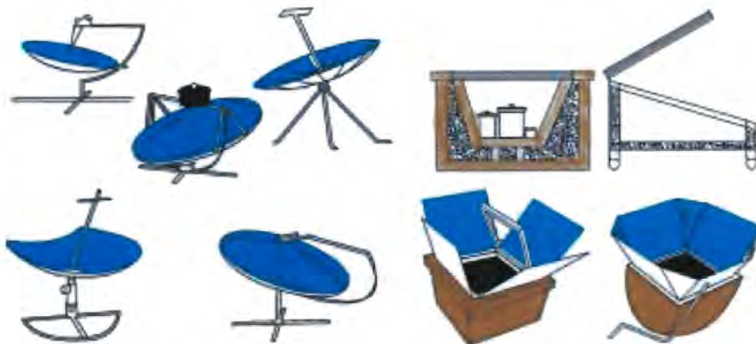
Fig. 1. Diferentes diseños de cocinas de concentración (izquierda) y de acumulación con concentradores, derecha.
