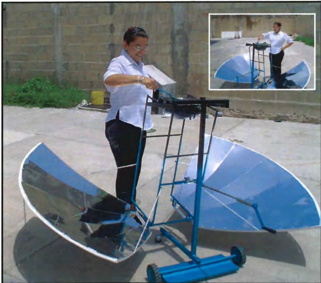
Fig. 16. El usuario debe colocarse adecuadamente por la parte trasera de la estufa. En donde no hay peligro de destellos que puedan ocasionar molestias en la vista, ya que adelante no hay ninguna superficie reflectora.
