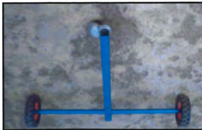
Fig. 12. Mecanismo de orientación de tres ruedas
