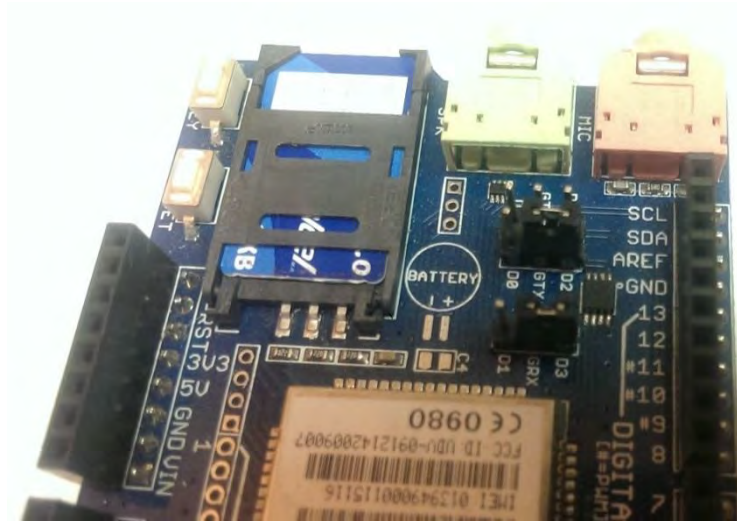
Figura 3.9. Puenteo de pines Tx y Rx.
