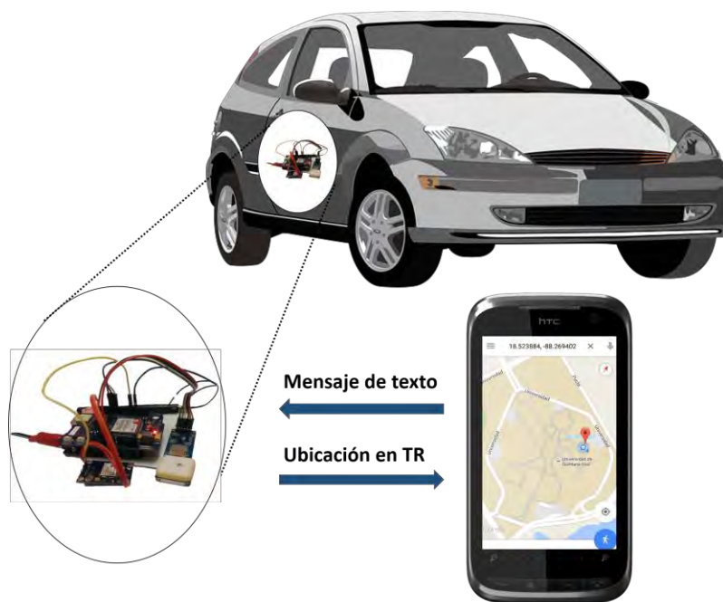
Figura 3.40. Funcionamiento básico del sistema.
