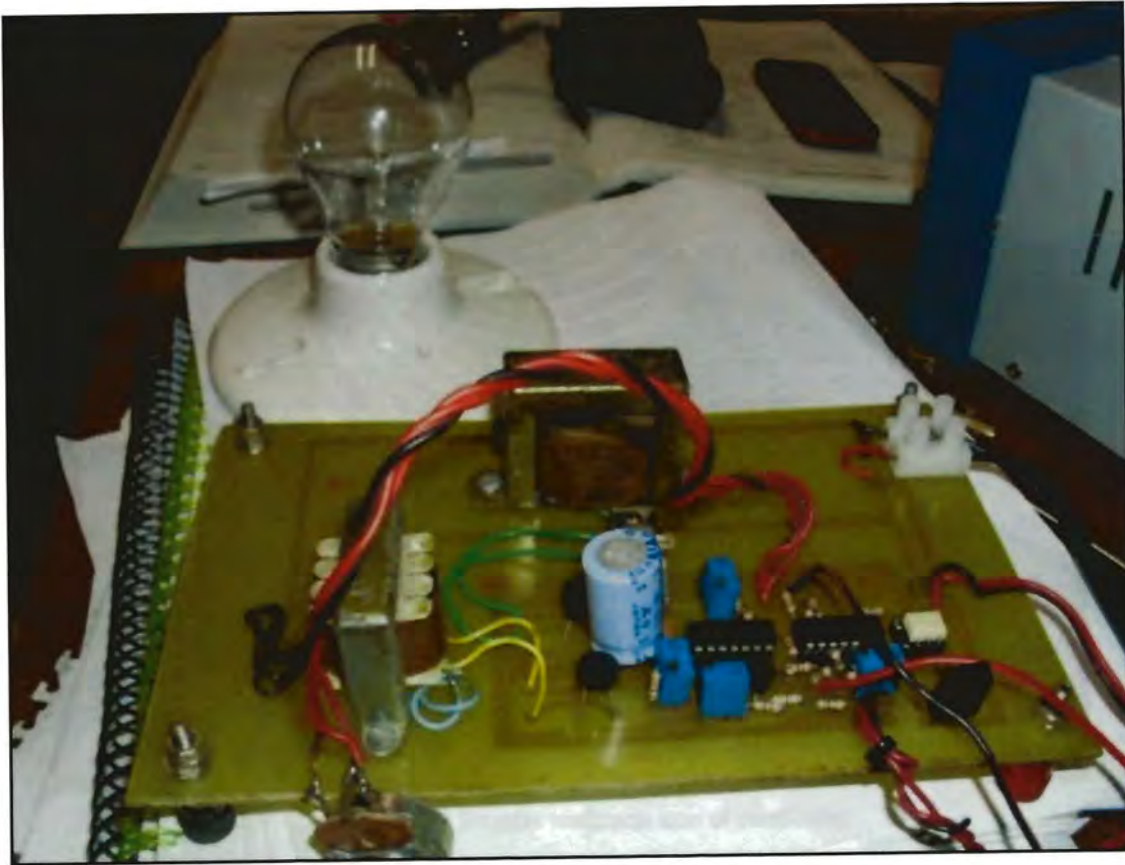
Figura 3.12 Prueba realizada con el foco.
