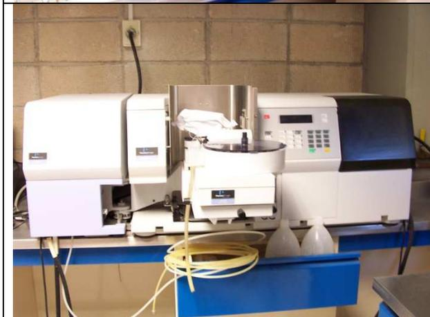
**Espectrometría de absorción atómica con llama y horno de grafito.** Sirve para detectar metales pesados con mayor sensibilidad, identifica hasta gases. La ventaja de este con el anterior es que es muy sensible y utiliza muy poca muestra.
