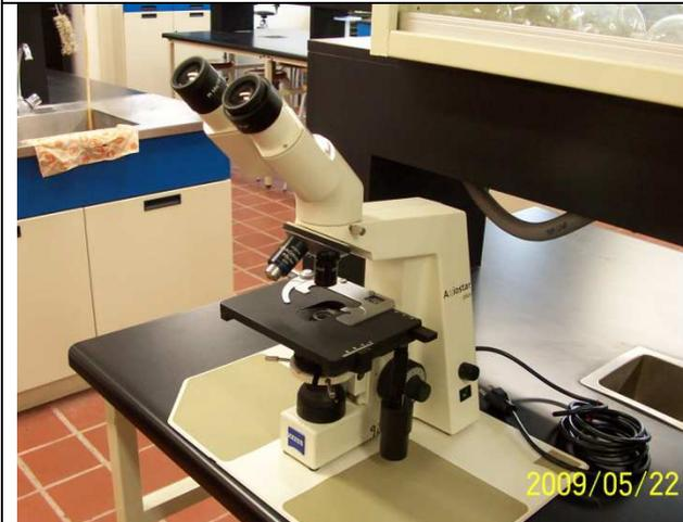
**Microscopio compuesto:** su uso es común en la criminalística, aun que existen modelos que se pueden conectar a un puente óptico, lo que permite visualizar por citar un ejemplo: el pelo de origen desconocido al mismo tiempo que el pelo de referencia. En este microscopio se pueden observar hasta 100 x (aumentos)
