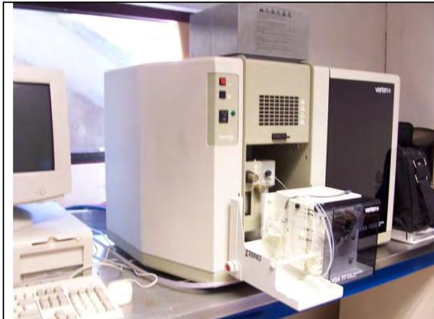
**Espectrofotómetro de absorción atómica:** permite identificar aproximadamente 66 elementos de la tabla. Su aplicación forense consiste en la determinación de residuos de disparos como plomo, bario, antimonio y cobre. Sirve para leer algún tipo de concentración como: la glucosa o algún elemento químico como mercurio, etc.
