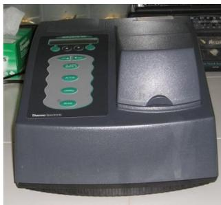
**Figura 2.6** Espectrofotómetro utilizado en la determinación de fósforo disponible.
