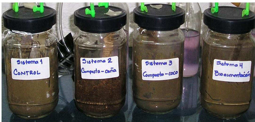
**Figura 2.2** Sistemas de biorremediación en los recipientes de ensayo.
