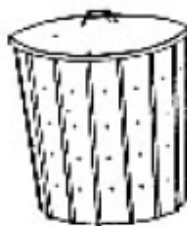
Deposito de compostaje de basura. (Asegúrese de que sea metal galvanizado ó plástico. Haga perforaciones para la ventilación)
