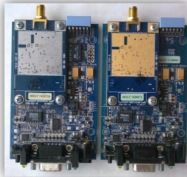
Figura 5. Módulos 9XTend OEM RF empleados en la investigación.
