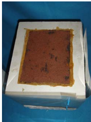
Figura 2.3.1.1 Cámara exterior, provista de una película transparente de acetato, como barrera contra las ráfagas de viento.
