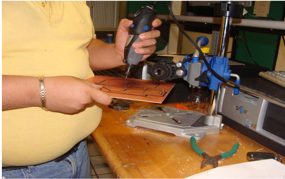
Figura 3.9.- Realizando los Huecos en las Donas del Circuito.
