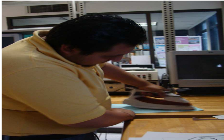
Figura 3.5.- Planchado del circuito.
