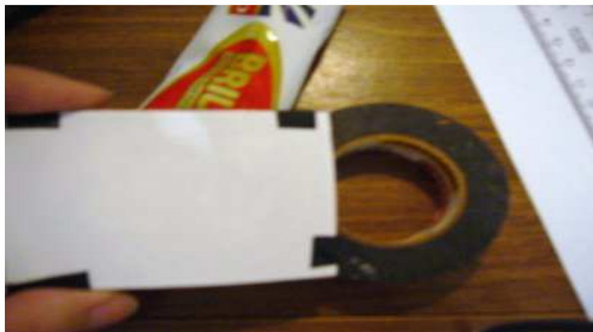
Figura 3.4.- Placa Fenólica con el circuito listo para planchar.
