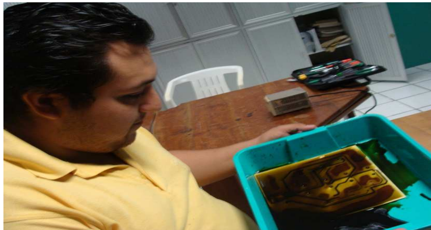
Figura 3.10.- Quemando el Circuito de la Placa.
