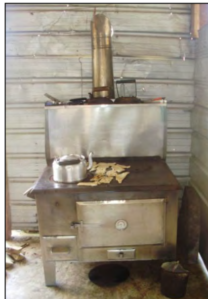
Estufa de leña con tres quemadores, comal, horno con termómetro, espacio para introducir el carbón, y cajitas donde se quedan almacenadas las cenizas, mismas que al llenarse se sacan, y el tubo de la chimenea.
