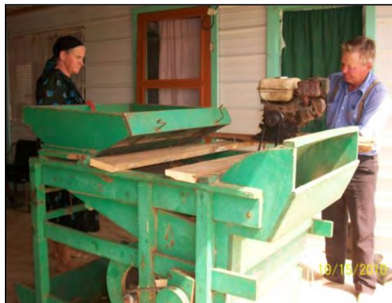
Los señores de la casa, nos enseñan la maquina que desprende los tubérculos del cacahuate del resto de la planta.
