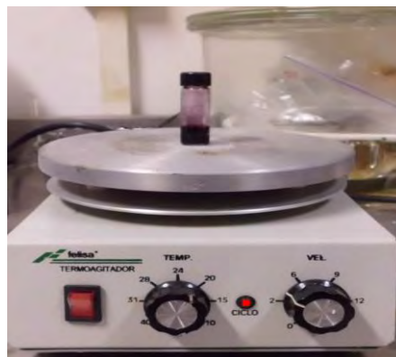
Figura 10. Agitación magnética de la mezcla de P3OT-MWCNT's.
