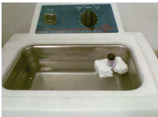
Figura 9. Dispersión en el baño ultrasónico de MWCNT'S.
