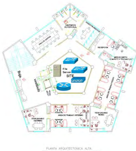
Figura 23. Ubicación física de los dispositivos dentro del edificio V (Planta Alta)
