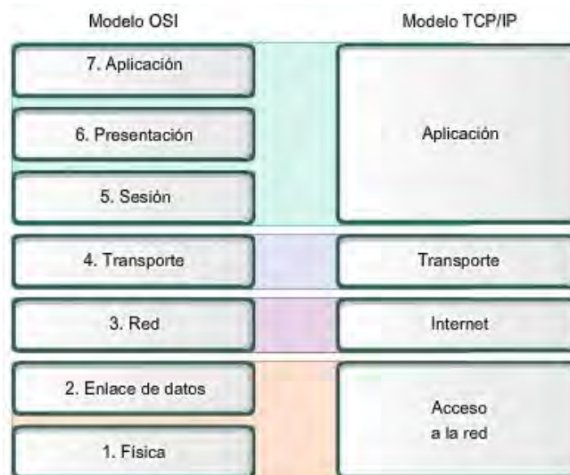
Figura 4. Comparativa entre el modelo OSI y TCP/IP (Fundamentos de redes de datos)
