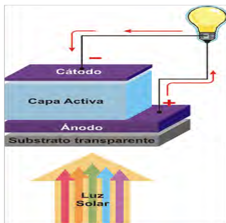
Figura III.7. Estructura básica de una celda solar.
