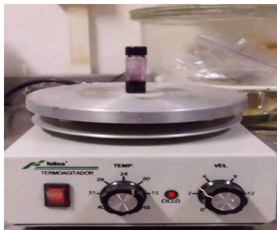
Figura III.3. Agitación magnéticamente del P3HT-grafeno.
