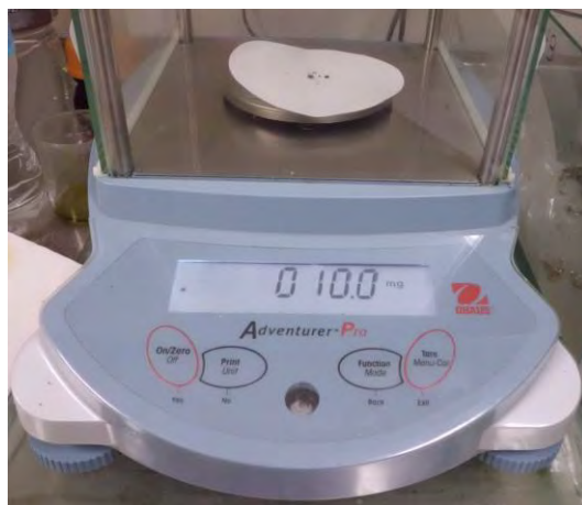
Figura III.1. Medición del P3HT, donde se pesó 10 mg de P3HT.
