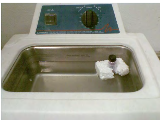
Figura III.2. Dispersión en baño ultrasónico del P3HT-grafeno.
