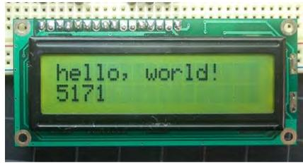
Ilustración 20: LCD (Liquid Crystal Display) de 16x2 (16 columnas y 2 filas).
