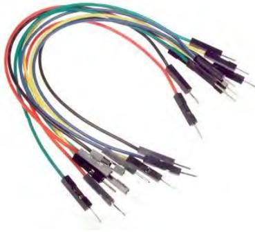
*Ilustración 16: Cables Jumper o Dupont.*
