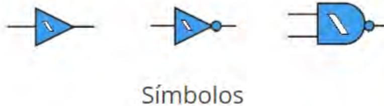
*Ilustración 25: Símbolos de compuertas Schmitt Trigger.*
