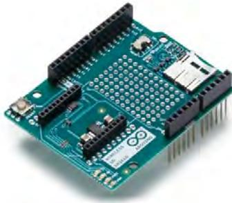
*Ilustración 14: Tarjeta wireless SD Shield de arduino.*
