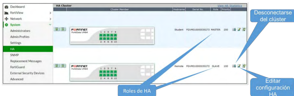
Figura 3-55. Monitor del clúster H.A
