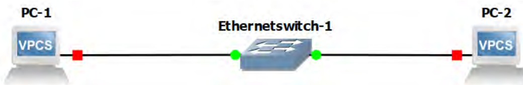
Figura 31. Topología con built-in de GNS3.
