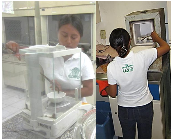
Figura 7. Pesaje e incineración de las cápsulas de porcelana para la determinación de sólidos.
