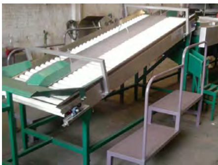
Imagen 2: Elevador con sistema de desechos (avileshernandez.com, 2017)
