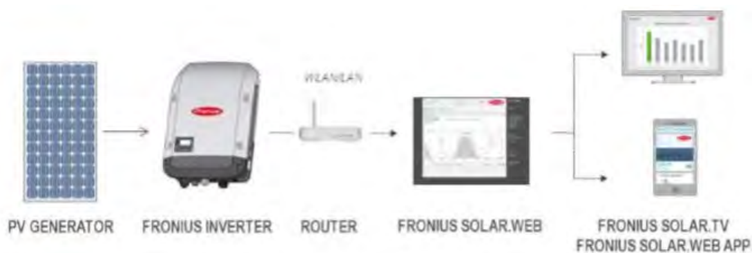
Figura 3.9. Sistema de monitoreo del Fronius Galvo 3.1-1. Fuente: Fronius
