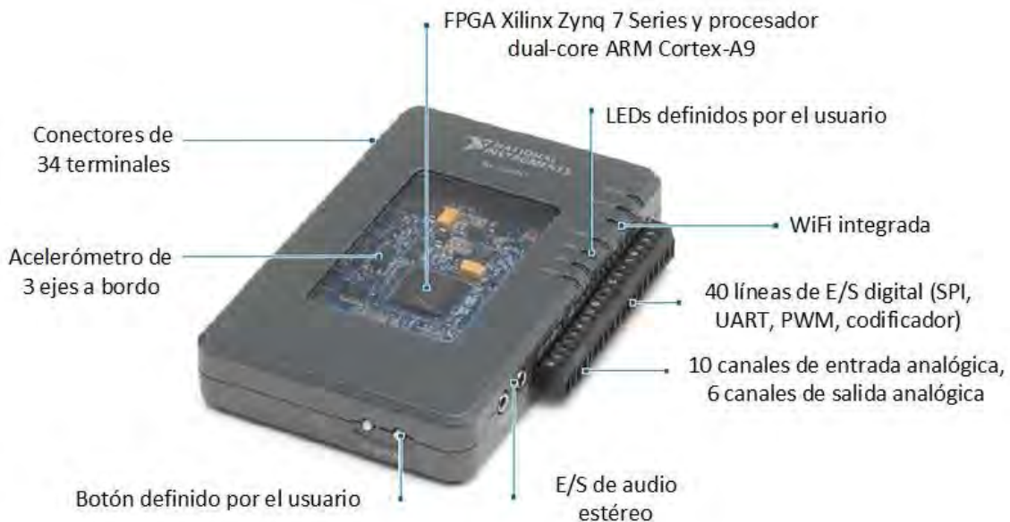
Figura 13. Equipo NI myRIO y sus elementos principales que lo conforman.
