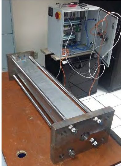
Figura 4.12. Imagen del cilindro montado en las placas superior e intermedia de la armadura de soporte.
