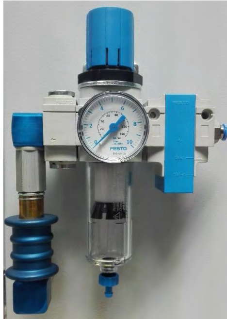
Figura 3.6. Imagen de la unidad de mantenimiento y la válvula de corredera instalados correctamente.
