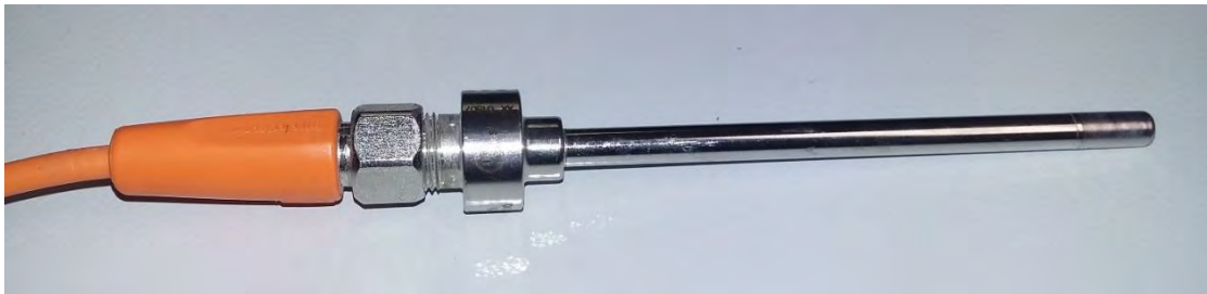
Figura 3.21. Imagen del sensor PT100 instalado en el sistema de prensado, la zona rugosa de la punta (2 cm) es la definida como ideal para la medición de la temperatura.
