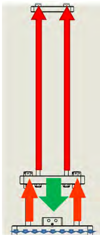
Figura 2.4. Diagrama de vectores fuerza sufridos por la armadura de soporte durante el ciclo de fuerza.
