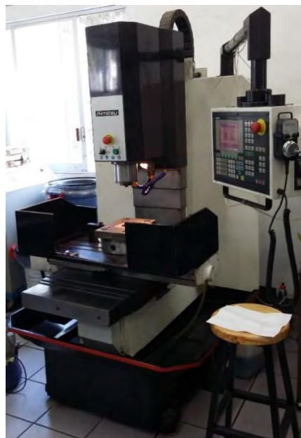
Figura 3.1. Fresadora CNC utilizada para el maquinado de las placas de soporte.
